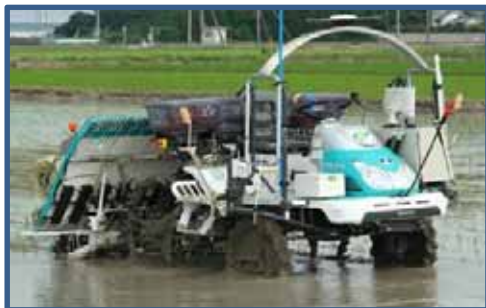
運転アシストシステムにより、苗継ぎ等で中断することなく移植作業が1人で可能に
